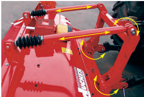
Aanbouwbok bij UM 27, 30 en 40 met draaipunten en afvering naar achteren
