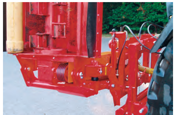
Hydraulische transportbeveiliging in transportstand
