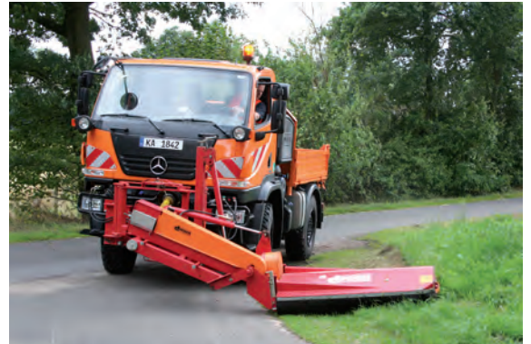
SMT 15 linkswerkend gemonteerd aan een Unimog U 20
