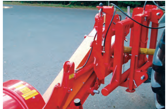
Hydraulische transportbeveiliging in werkstand
