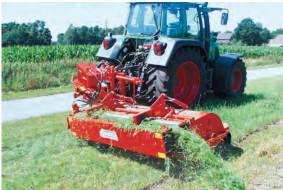
USM met afvoerband voor het zijdelings weglekken van het gemaaide product
