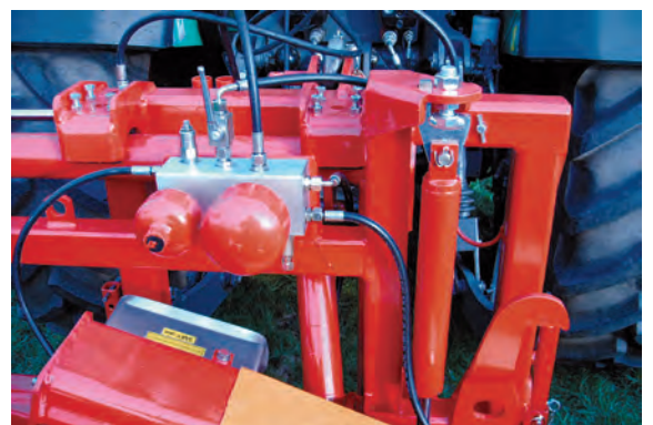
Centraal hydraulisch ventiel met stikstofbollen
