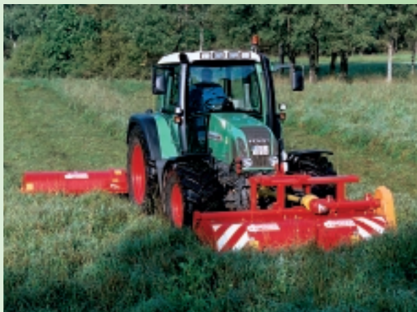
Afb. 9.4: Combinatie UM 27 front- en USM 18 in achteraanbouw
