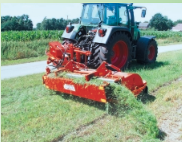
Afb. 7.4: USM met afvoerband voor het zijdelings afleggen van het gemaaide product
