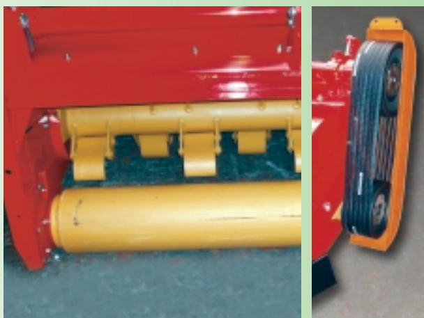
Afb. 5.4: Klepelas, looprol en V-snaar overbrenging
