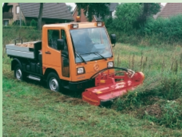
UMT 15 met hydraulische aandrijving, frontaansbouw
