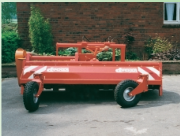
Afb. 5.3: UM 27 met zwenkbare wielen (standaard 2 wielen)
