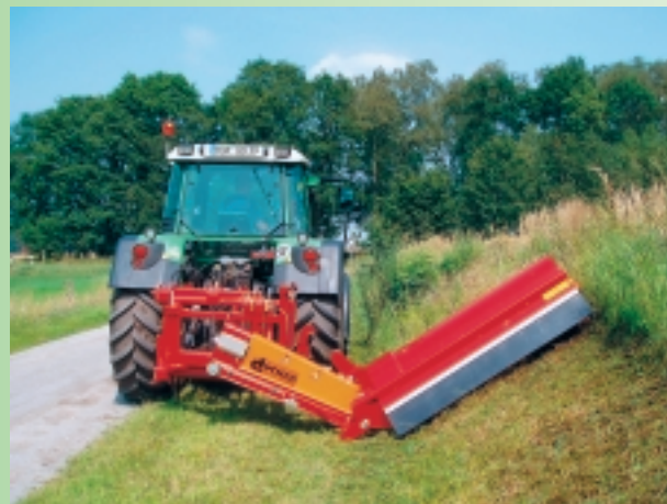
Afb. 6.3: USM 18 bij het maaien van een talud
