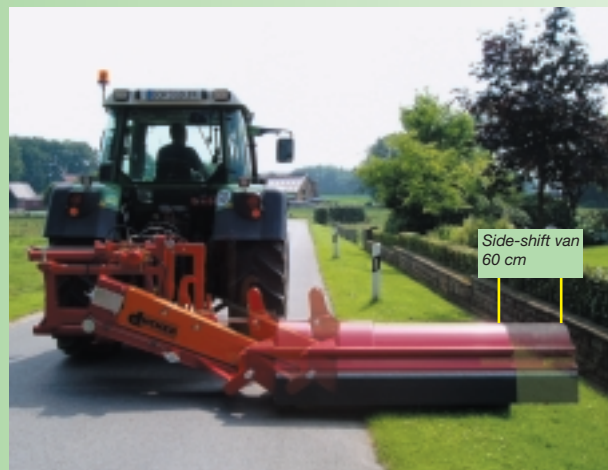
Afb. 6.4: USM 18 met side-shift
