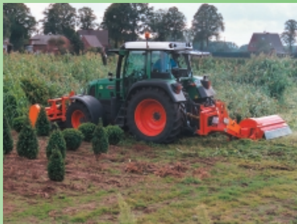
Afb. 9.5: Combinatie UM 27 front- en USM 18 in achteraanbouw
