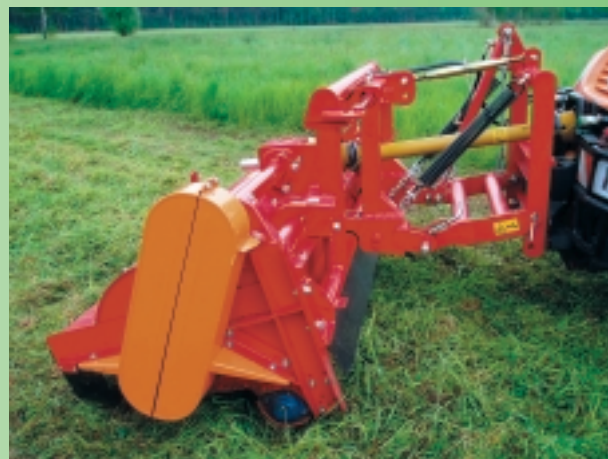
Afb. 5.5: Bodemontlastingsveren in frontaanbouw
