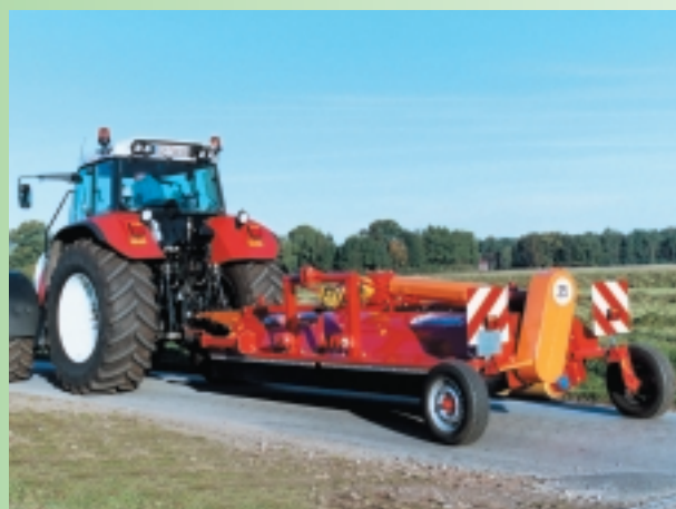
Afb. 4.4: UM 40 met lengtetransport
