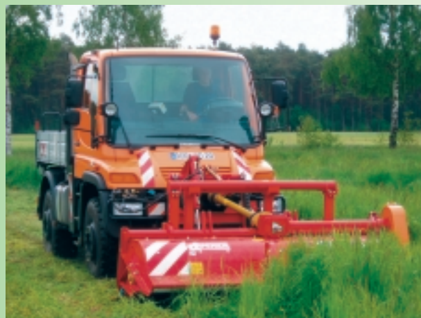
Afb. 4.2: UM 27 frontaanbouw met side-shift
