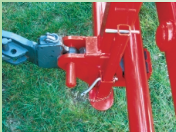
Afb. 8.6: Zeer stabiele onderaanspanningspunten
