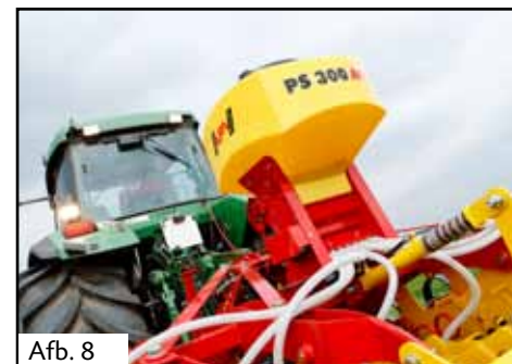
Afb. 8, 9 & 10: PS machine monteren op de GP 300 M1
