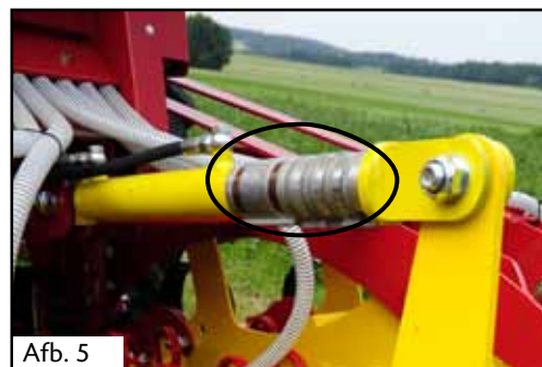
Afb. 5: Verstelling van de nalooprollen
