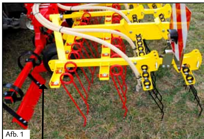
Afb. 1: Diepteverstelling v/d voorste rijen tanden
