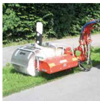
LPW 500 Reflectorpaal- en verkeersbordwasborstel Werkbreedte: 500 mm Toerental: 375 t/min Gewicht: 150 kg
