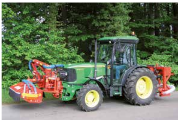
UNA 200 in transportstand aan een John Deere trekker, met gedeelde bouwvorm
