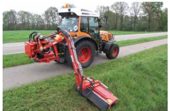
KBM 350 in driepuntsaansbouw met klepelmaaier
