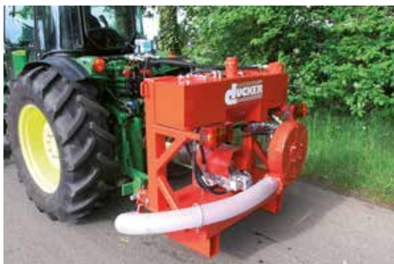
Hydrauliekinstallatie in de driepuntshof (gedeelte bouwvorm), optioneel met blazer
