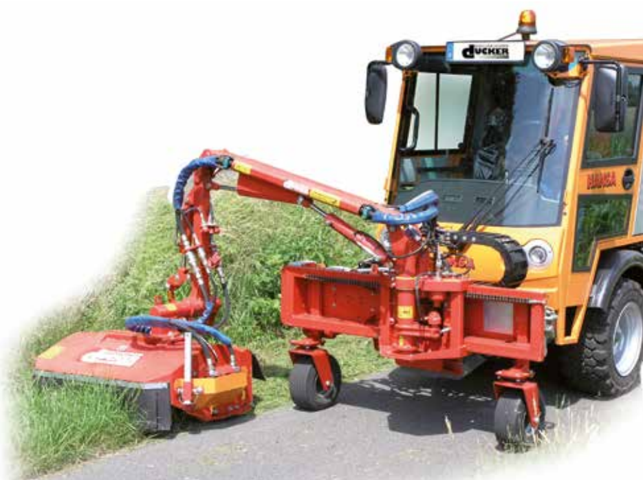
UNA 200 in transportstand aan een John Deere trekker, met gedeelde bouwvorm
