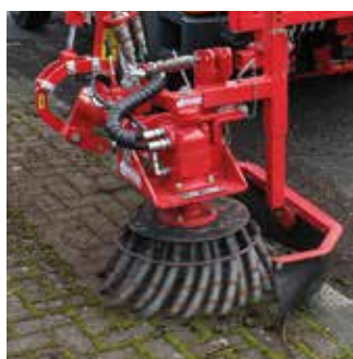
PFP 600 Onkruidborstel Werkbreedte: 600 mm Rotortoerental: 150 t/min Gewicht: 140 kg
