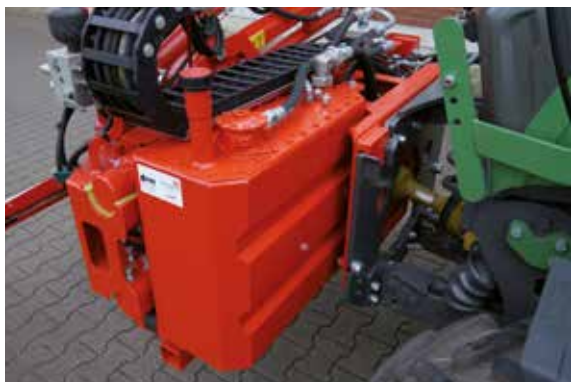
DBM 400, geïntegreerde hydraulieksinstallatie
