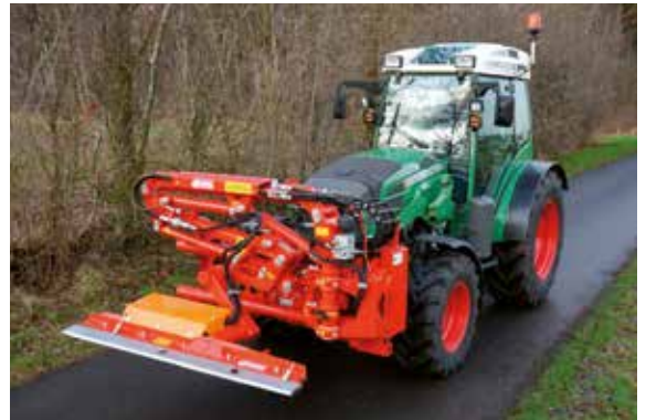
DBM 400 in transportstand aan een Fendt trekker
