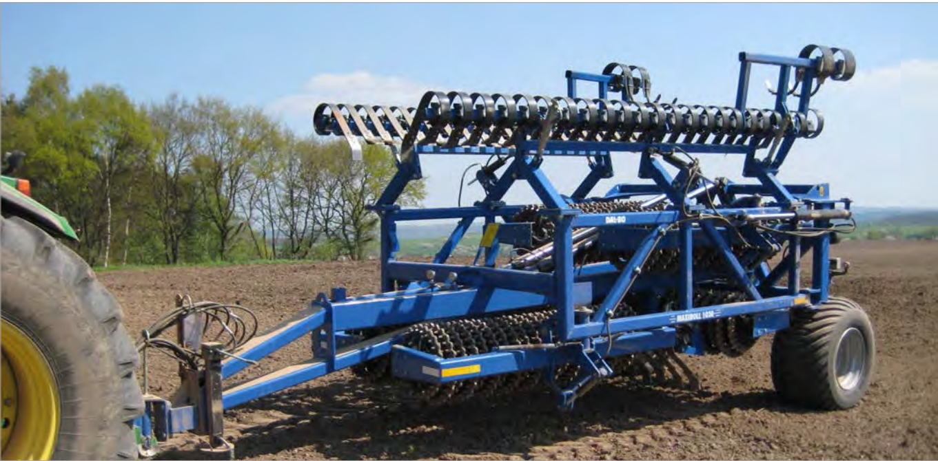
Crackerboard Hydraulisch verstelbaar Crackerboard met parallellogramgeleiding, uitgevoerd met 100x12mm tanden van veerstaal en speciale slijtplaten. Debediening is volledig hydraulisch vanaf tractorzitplaats. Voor alleen narollen kan het Crackerboard hydraulisch omhoog gezwenkt worden.
