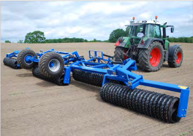
Nadat de walsen volledig zijn uitgeklapt, zakken ze op de bodem en wordt het onderstel van de grond geheven
