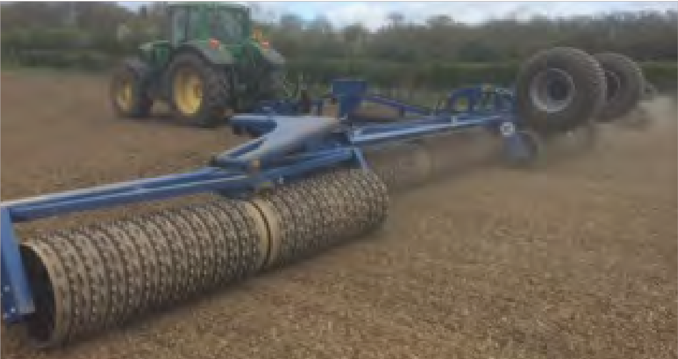
De walsen werken over de totale breedte zeer gelijkmatig en bereiken een optimale versteviging.
