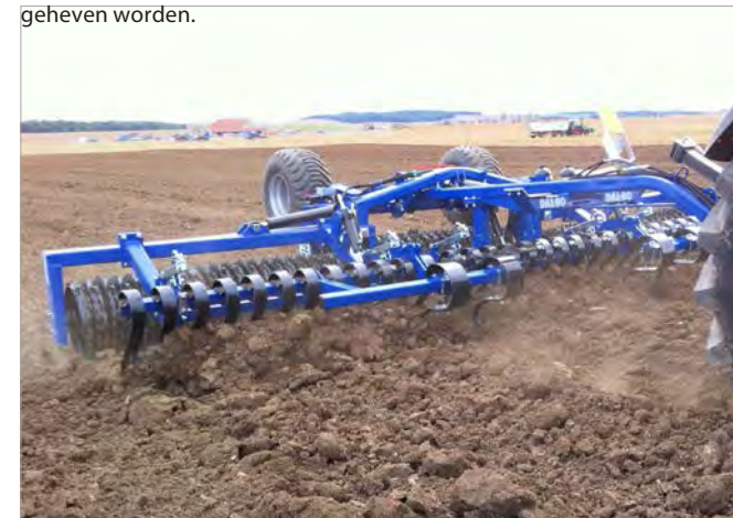
Crackerboard Hydraulisch bedienbaar Crackerboard met extra sterke 80x100mm tanden, parallellogramgeleiding en traploze werkhoeekverstelling via spindels. Standaard uitgevoerd met drie gelijklopende cilinders voor exacte dieptegeleiding en hoekvormige slijtplaten 100x12mm
