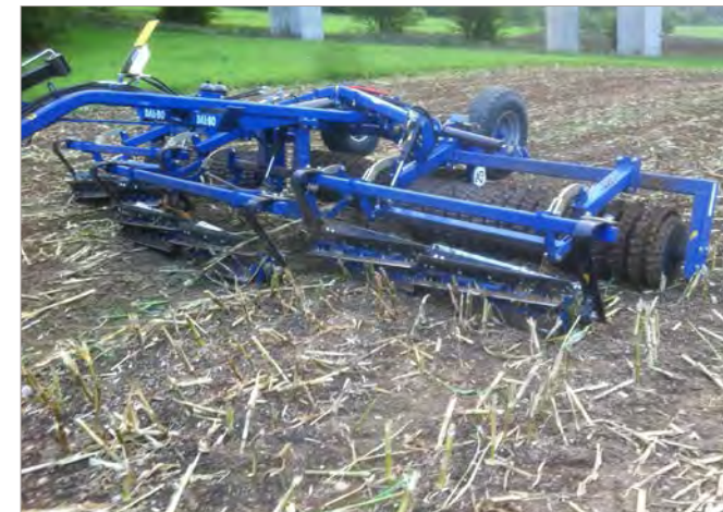
Messenwals 350mm messenwals radiaal uitgevoerd met 6 sets boorstaal geharde messen. De messensegmenten kunnen via N-bal traploos tot 70 bar druk worden ingesteld. De bediening vindt volledig hydraulisch plaats vanaf de tractorzitplaats. Bij alleen narollen kan de messenwals hydraulisch omhoog gezwenkt worden.
