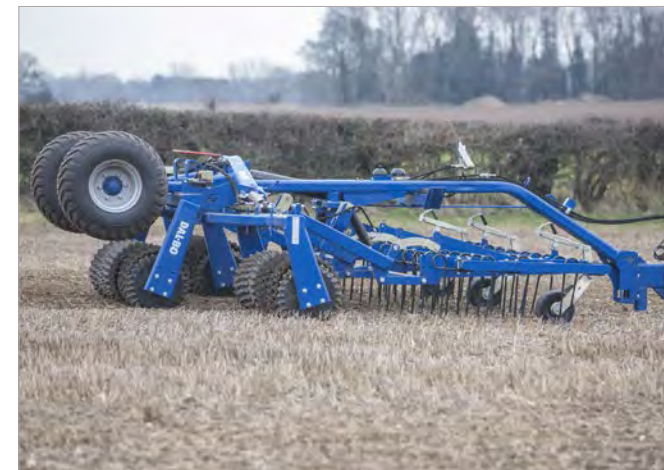
4-rijige kuktivator stro Hydraulisch bedienbare r 4-rijige strocultivator uitgevoerd met 14mm tanden en dieptegeleidingswielen van staal voor de exacte dieptegeleiding. Voor aanwalsen kan de cultivator hydraulisch
