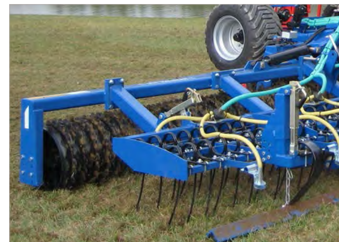
2-rijige cultuureg voor grasland Hydraulisch bedienbare tweerijige graslandeg met parallellogramgeleiding en sterke 12mm tanden incl. verliesbeveiliging. De exacte dieptegeleiding via geleidingswielen van staal. De grslandeg kan met een geveerd egalisatiebord (zie extra uitvoeringen greenline) uitgevoerd worden.
