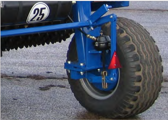
Die Walzen können als Sonderausstattung mit hydraulischen Bremsen oder Druckluftbremsen ausgestattet werden.
