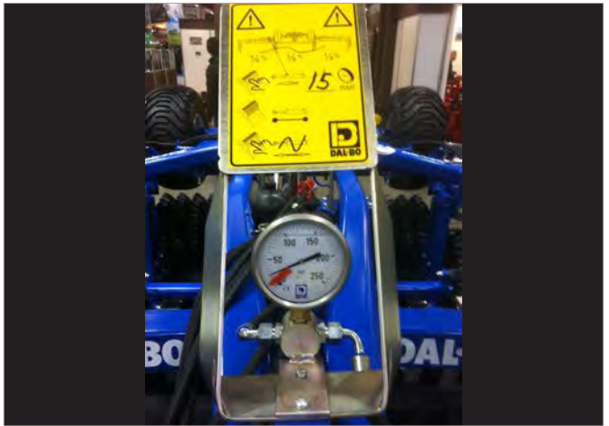
MaxiRoll is serienmäßig ab Werk mit einer hydraulischen Gewichtsverteilung ausgestattet. Ein großes Manometer erleichtert die Bedienung.
