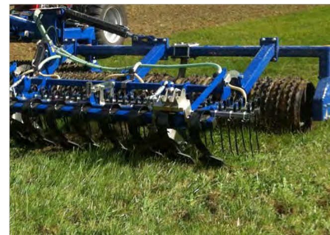
2-rijige cultuureg met Crackerboard Hydraulisch bedienbare tweerijige graslandeg met voor gemonteerd Cracker-board, parallellogram-geleid sterke 12mm taanden incl. verliesbeveiliging. De exacte dieptegeleiding via geleidewielen van staal.
