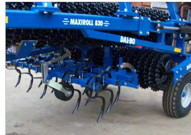
Cultivator Hydraulisch bedienbare 3-rijig met parallellogram-geleiding, super-Q-tanden en geleidewielen van staal. Voor aanwalsen kan de cultivator hydraulisch worden geheven
