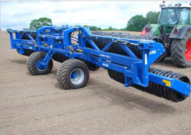
Aansluitend worden de buitenste zijdelen door een geraffineerde zwenkcoulisse uitgeklapt.
