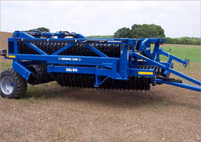
De compact opgeklapte minimax heeft slechts 3m transportbreedte en een zeer geringe transportlengte.
