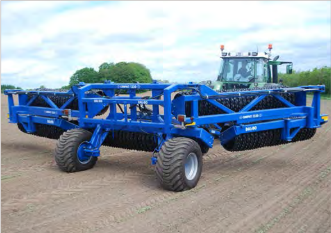
Eerst vindt het heffen uit de automatische transportstand plaats en het uitklappen van de binnenste zijdelen.
