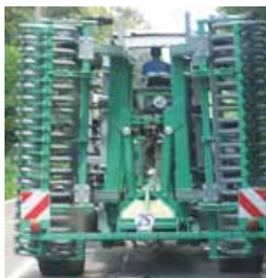
Transportstand met 2,90 m buiten breedte met hydr. beveiliging
