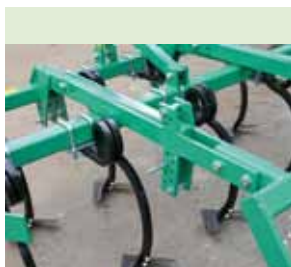
diepteverstelling met pen/gat systeem
