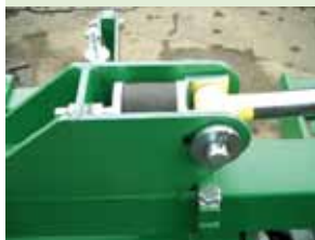
Rubber veerelementen aan de opklapdelen zorgen voor optimale bodemaanpassing
