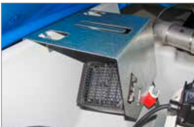
CUBE-AdBlue®-tank, met verwarming en thermostaat
