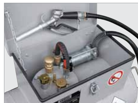
pompkast met handpomp 25 l/min, 1,5 m aftapslang en handtankpistool
