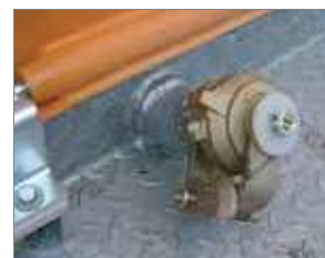
ASS-koppeling gemonteerd (zonder toebehoren)
