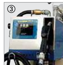
elektropomp 50 l/min in beschermkast
