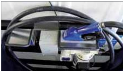
console met pomp, tankpistool- en slanghouder
