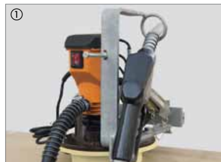
elektropomp 40 l/min met automatisch-tankpistool
