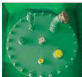
mangatdeksel met aansluitingen
