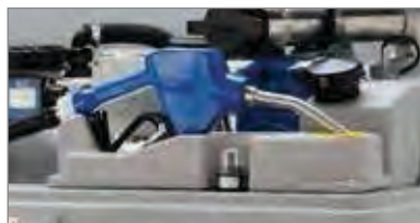
De geïntegreerde tankpistoolhouder levert een veilig systeem.
