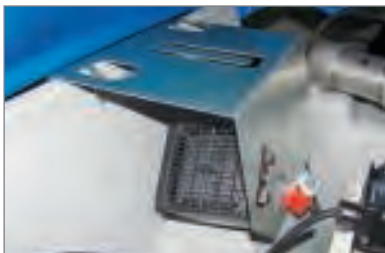
CUBE-tank voor AdBlue®, verwarming en thermostaat
