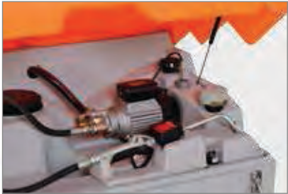
Elektrotandwielpomp 230V, 9l/min, 12 bar en digitale handdoorloopteller voor smeerolie (niet voor ijen geschikt*)
