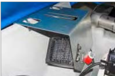
CUBE-AdBlue®-tank, met verwarming en thermostaat
