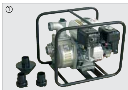
motorpomp tot 500 l/min met Honda-benzinemotor
