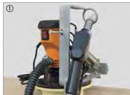
elektropomp 40 l/min met automatisch-tankpistool
