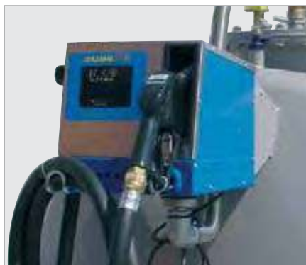
elektropomp CUBE 70 K33 (details zie blz. 82)
