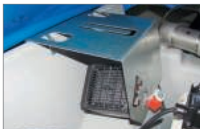
CUBE-tank voor AdBlue®, verwarming en thermostaat
