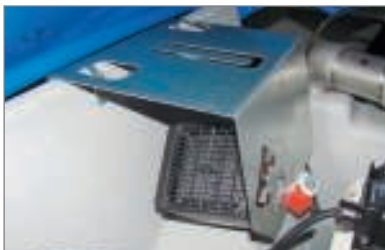
CUBE-tank voor AdBlue®, verwarming en thermostaat
