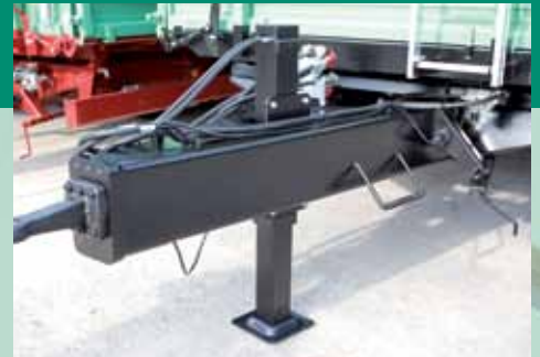
hydraulische steunpoot dubbelwerkend, buis-in-buis geleiding
