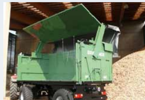
hydraulische stabilisatorzijwand naar boven geopend
