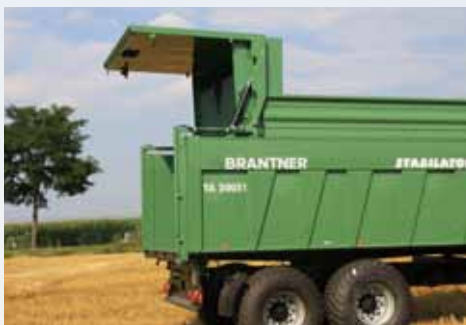
hydraulische achterklepopening dubbelwerkend
