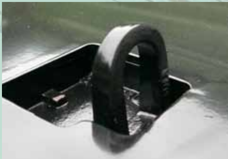
Bevestigingshaken EN 12640 in de laadvloer verzonken
