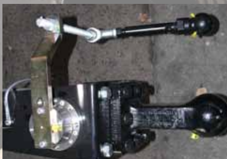
Elektrische zweekbesturing vergrendelen bij achteruit rijden en wegtransport niet vereist
