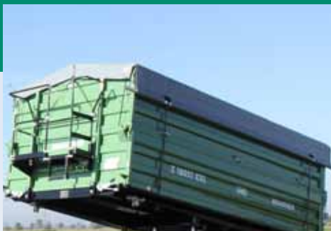
Bovenbouw afscherming met opzetdriehoeken en bedieningsplatform
