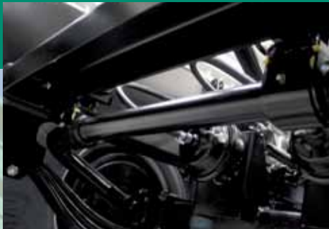
Veerstabilisator voor optimale rijeigenschappen
