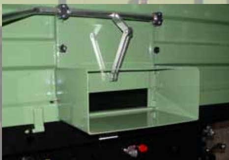
Uitloopgoot niet afsluitbaar
