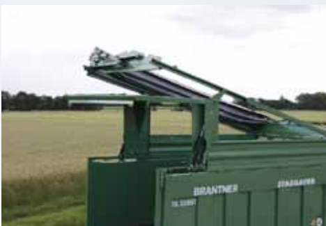
Cabrio bovenbouwbescherming in combinatie met hydraulische achterwand
