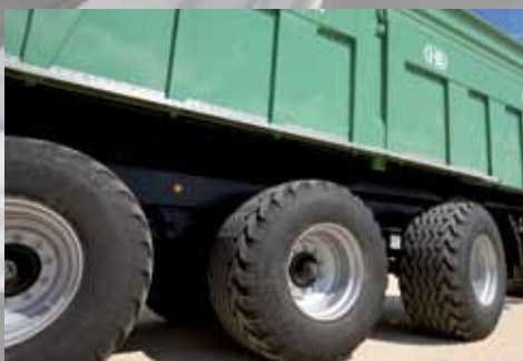
Gestuurde as verhoogd de wendbaarheid en reduceert de bandenslijtage
