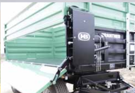
hydraulische bordwandopening zijdelings 180° openen en sluiten
