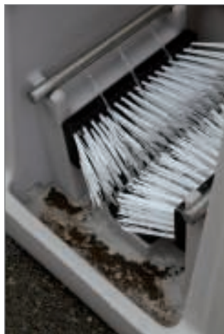
Verzamelbak voor verzamelen en afvoeren v/h vuile water
