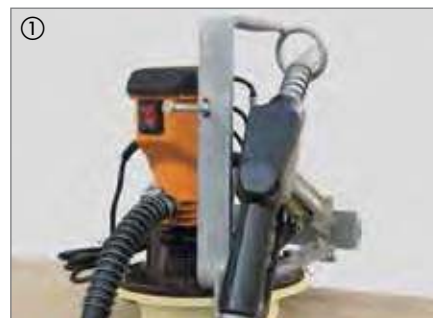
elektropomp 40 l/min met automatisch-tankpistool
