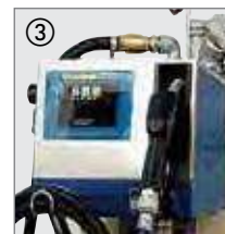
elektropomp 50 l/min in beschermkast
