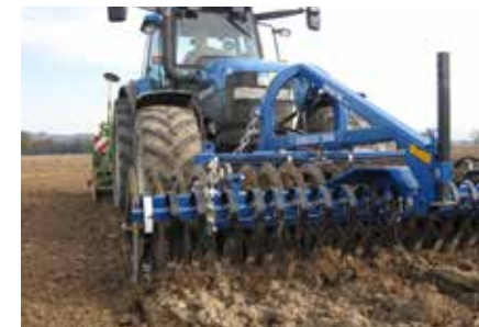
Crackerboard met 45x10mm tanden
