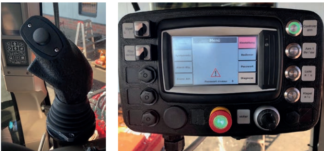
CAN-BUS Steuerung mit ergonomische Joystick ohne Ebeneumschaltung
