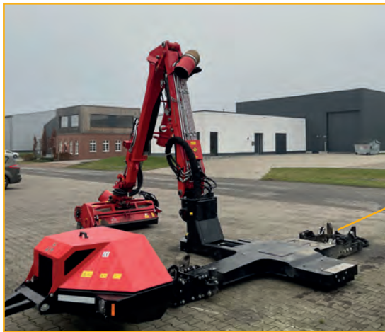
Hefmastconstructie van overrijdbaar frame
