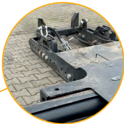
Hefmastconstructie van overrijdbaar frame
