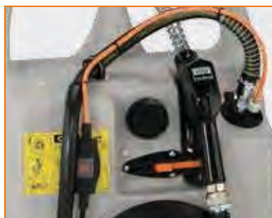
Knikbescherming + draaischarnier + afsluitkraan
