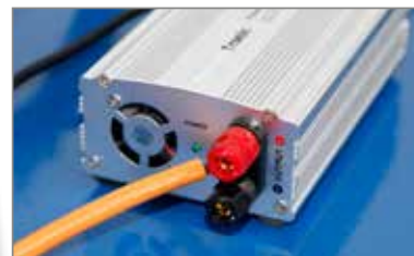
Kabelaansluiting direct aan de omvormer 230V (Varianten 10590, 10591, 10592)
