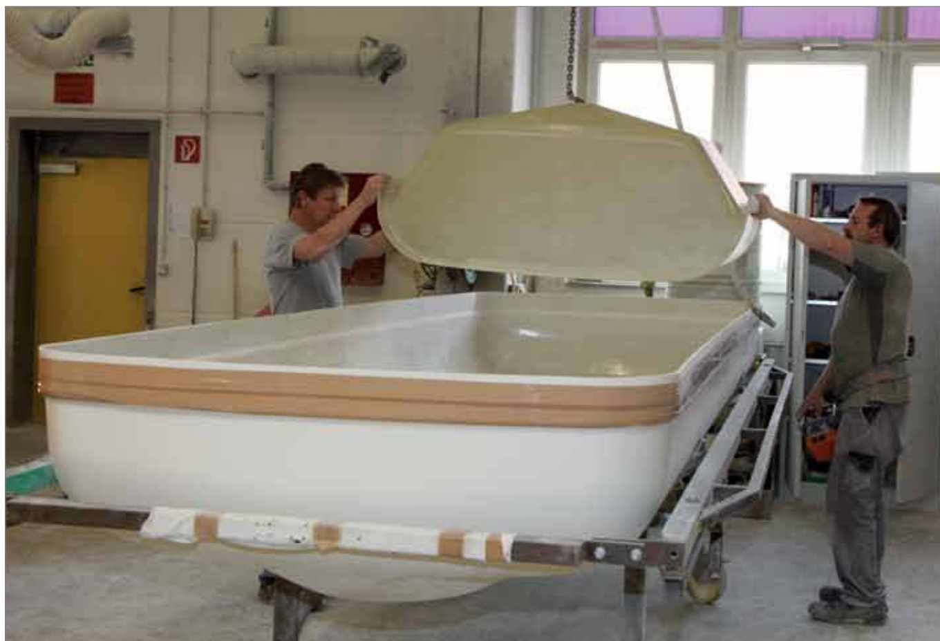
monteren van klotswanden in GVK -vat
