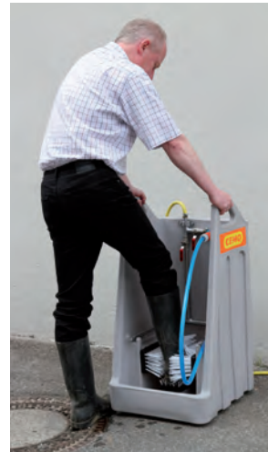
verzamelbak voor verzamen en afvoeren v/h vuile water
