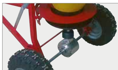
robuste aandrijving met aluminium huis
