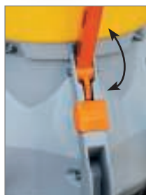
strooihoeveelheid instelbaar met vaste aanslag
