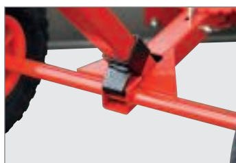
geblokkeerde duwdissel voor het „gebruik”
