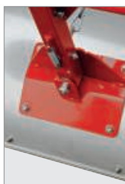
stabiele stalen constructie en RVS sneeuwboard met stootdemping
