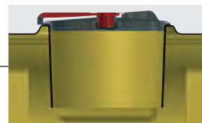
mangat met klotsbeschermer en klepdeksel
