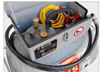
pompkast (KS-mobiel 200l) met elektropomp 12V, 25 l/min, ATEX, 4 mtr. vulslang en automatisch-tankpistool
