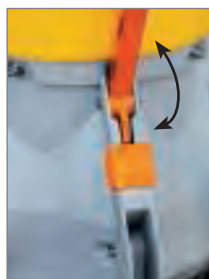
strooihoeveelheid instelbaar met vaste aanslag
