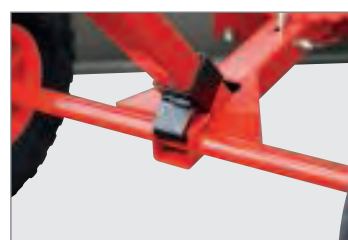
geblokkeerde duwdissel voor het „gebruik”
