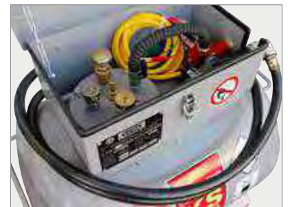
pompkastn (KS-mobiel 200l) met elektropomp 12V, 25 l/min, ATEX, 4 mtr. vulslang en automatisch-tankpistool
