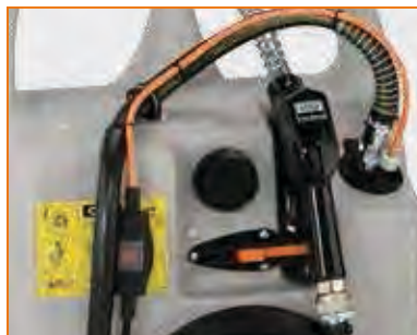
Knikbescherming + draaischarnier + afsluitkraan
