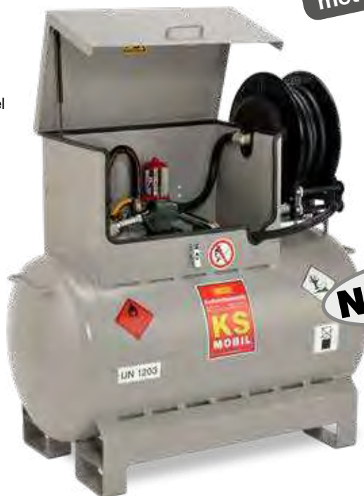
KS-mobiel 300l met elektropomp 12V, 25 l/min, ATEX, slanghaspel (toebereiden) en automatisch-tankpistool
